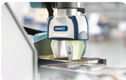
La pinza colaborativa de SCHUNK asegura una interacción flexible entre el humano y la máquina durante la carga de la máquina herramienta
