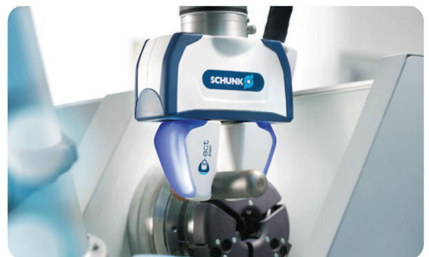
La pinza colaborativa de SCHUNK señala permanentemente mediante luces LED su estado actual al empleado
